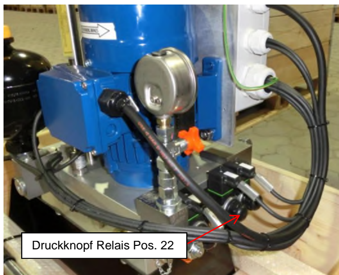
Abbildung 5-8: Hydraulikaggregat - System Druckentlasten
